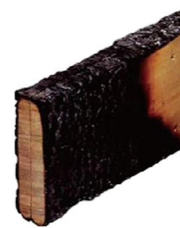
実験後にカットした木の断面 写真:一般社団法人日本ツーバイフォー建築協会
