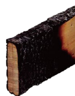
実験後にカットした木の断面 写真:一般社団法人日本ツーバイフォー建築協会
